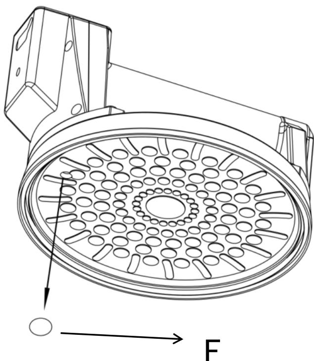
**Achtung! Ist die weiße Filtermatte (F) stark verschmutzt, sollte sie rechtzeitig gegen eine mitgelieferte Ersatzfiltermatte getauscht werden. Ein verstopfter Filter kann die Ansaugöffnung blockieren und den Betrieb stören.**
